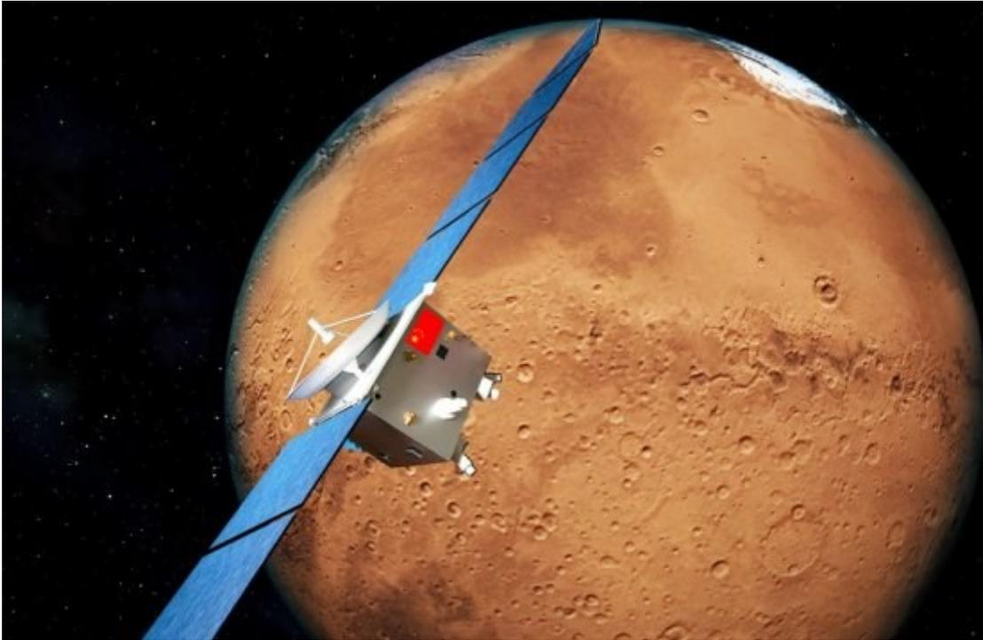
萤火一号由航天科技集团公司所属上海航天技术研究院研制，长、宽各约75厘米，高60厘米。两侧太阳翼展开7.85米，质量约115公斤，设计寿命2年，携带等离子体探测包、磁通门磁强计、掩星接收机、光学成像仪等4种探测仪器，主要科学探测目标是对火星的空间磁场、电离层和粒子分布变化规律，以及火星大气离子逃逸率进行探测，此外，还将探测火星地形地貌、沙尘暴以及火星赤道附近的重力场。萤火一号与福布斯-土壤探测器分离后进入环绕火星轨道，探测火星及其空间环境、探寻火星水的消失机制、揭示类地行星空间环境演化特征，双方还将配合开展掩星探测试验。
